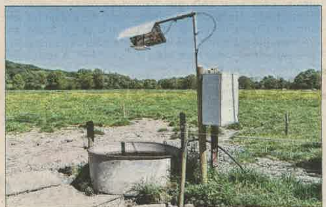
Dispositif pour évaluer la consommation d'eau des bovins charolais au pâturage (boitier blanc) et capteur pour détecter le passage des animaux (au-dessus de l'abreuvoir). Photo JSL/Damien VALETTE
